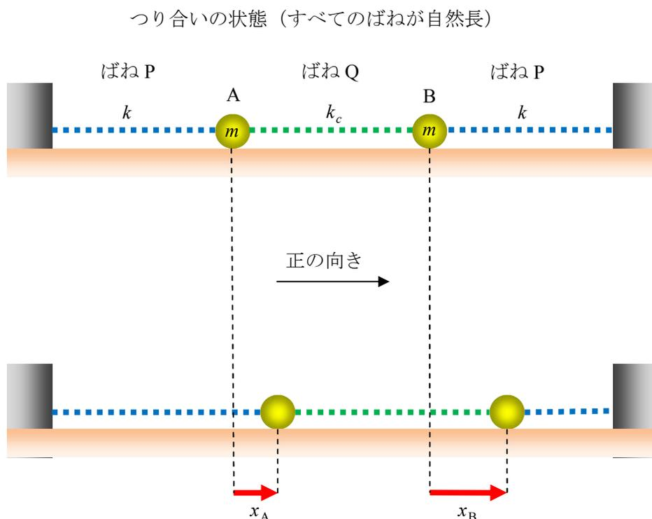
質量  $m$  の等しい 2 つの球 A と B が，図のように，ばね P (ばね定数  $k$ ) とばね Q (ばね定数  $k_c$ ) の 3 個のばねに直線状に結ばれて，摩擦のない水平面上に置かれている。
